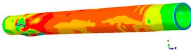
Рисунок 9 – Результаты разрушения обечайки № 3
