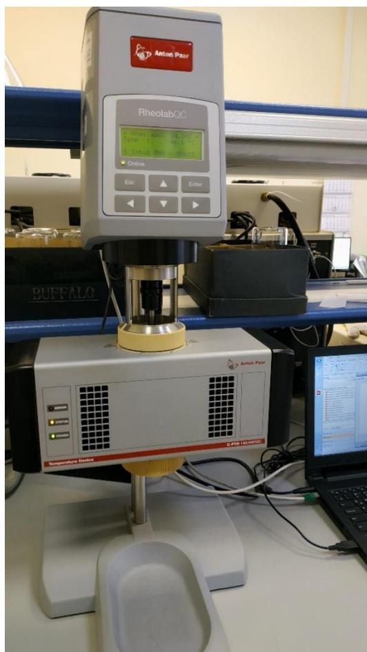
Рисунок 11- Ротационный вискозиметр RheolabQC
