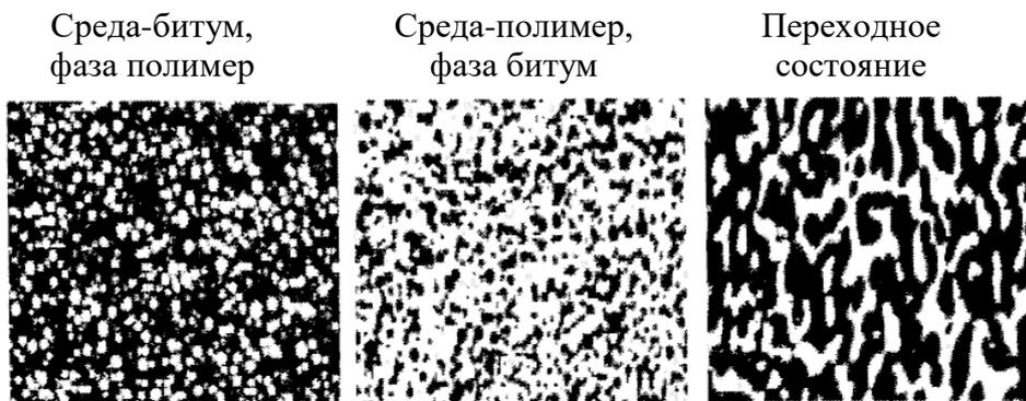
Рисунок 4 - Фазовые состояния битумов, модифицированных полимерами
