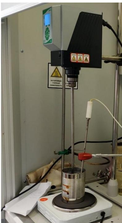
Рисунок 6 - Лабораторная установка для приготовления полимерно-модифицированного битумного вяжущего
