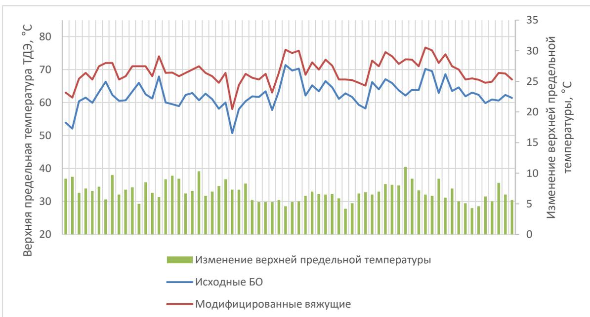
Рисунок 32 - Верхняя предельная температура ТДЭ вяжущего до и после модификации и ее изменение
