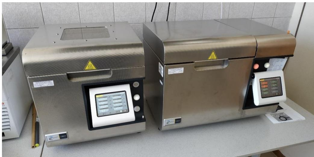
Рисунок 10 - Комплект оборудования для проведения испытаний вяжущих на стойкость к старению по методу PAV.
