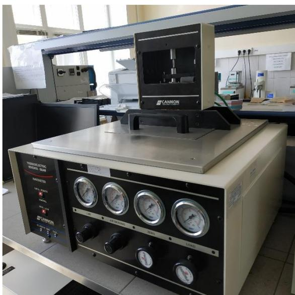
Рисунок 8 - Реометр для испытания образца-балки на изгиб (BBR)
