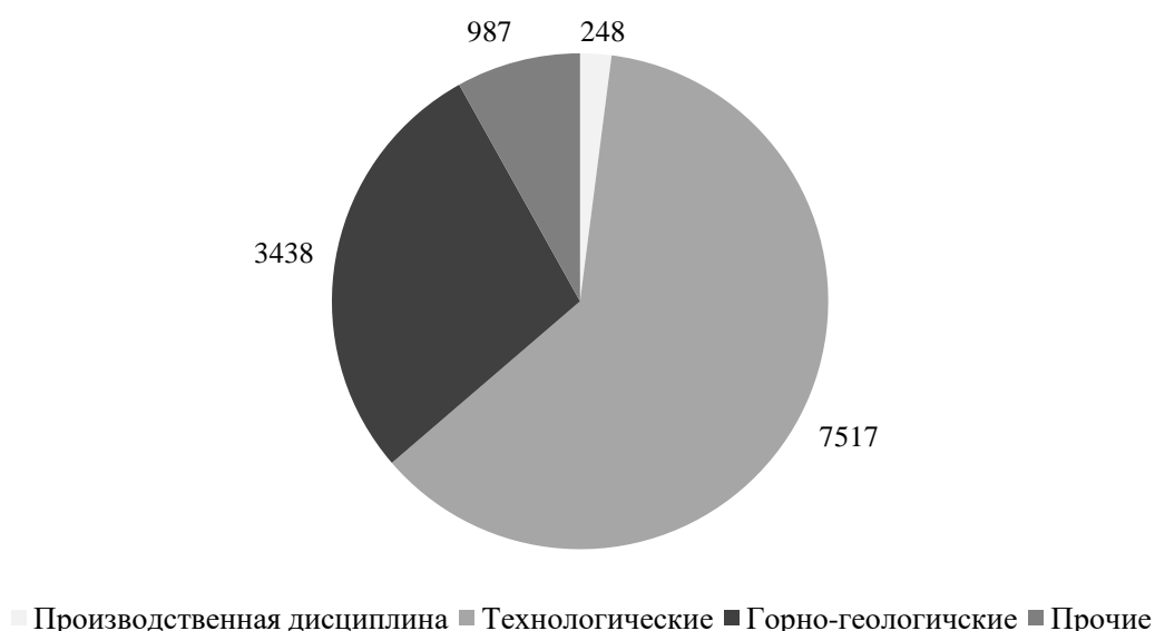
Рисунок 1 – Распределение непроизводительного времени (в часах) при строительстве скважин на месторождениях Западной Сибири за 2016 г. 1
