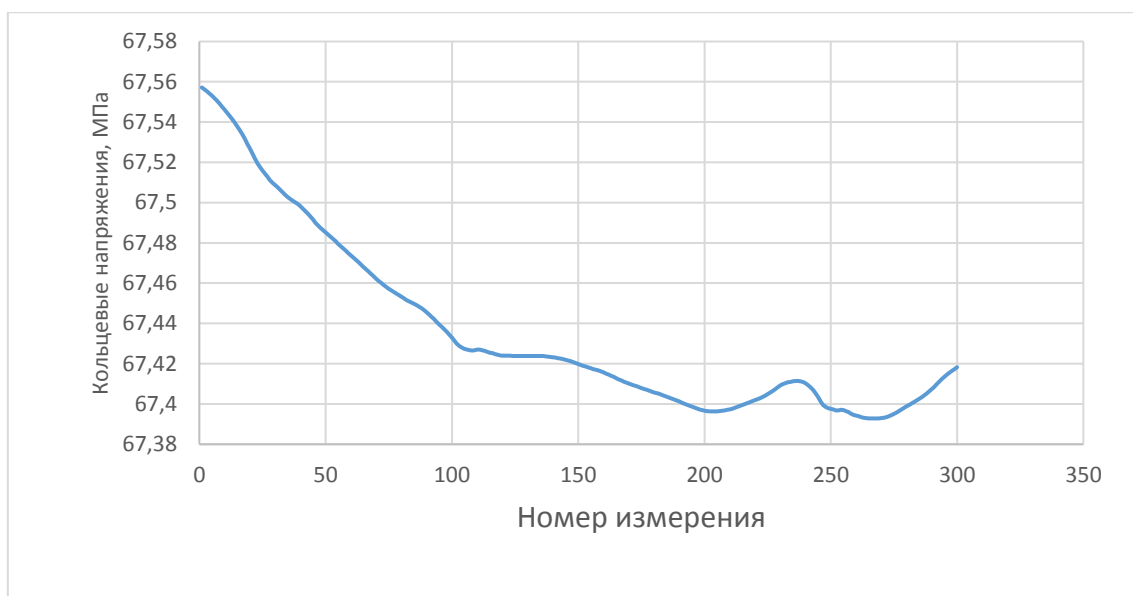
Рисунок 11 – Тренд кольцевых напряжений после обработки вейвлетом Добеши
