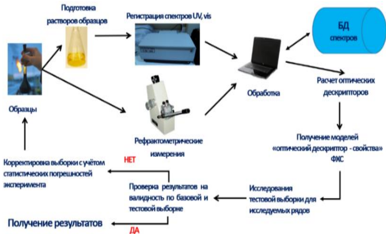
Рисунок 11 – Схема прогноза ФХС углеводородного сырья по оптическим дескрипторам в условиях заводской лаборатории
