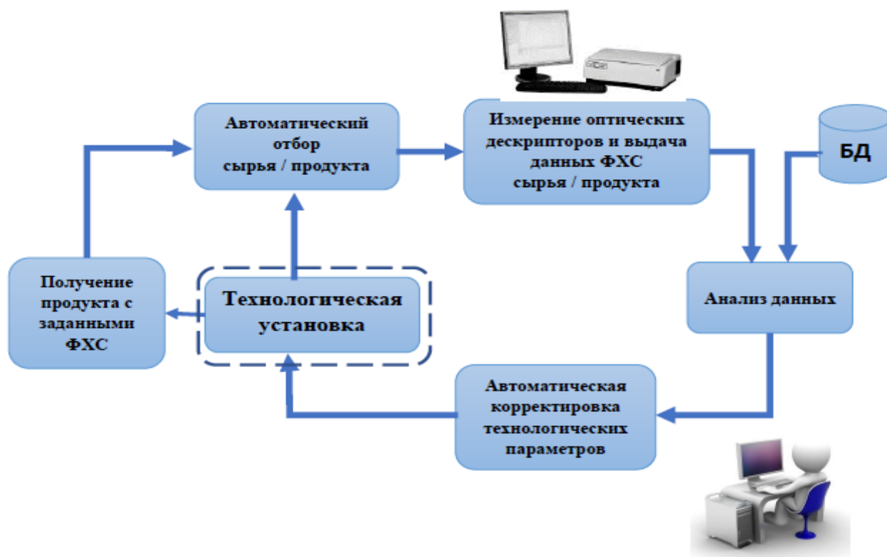
Рисунок 12 – Использование закономерностей «спектр-свойства» в системе автоматического контроля качества сырья и нефтепродуктов на НПЗ
