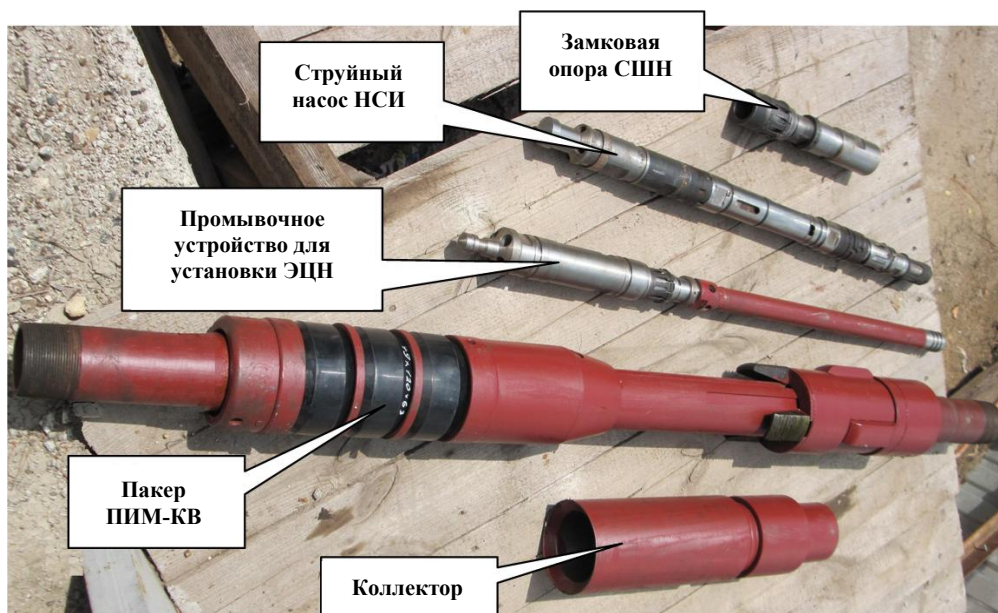
Рисунок 4.15 – Внутрискважинное оборудование установки ОРД –ЭЦН-СШН
