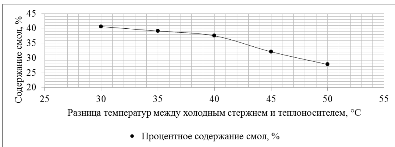
Рисунок 5 – График зависимости процентного содержания смол от разницы температур
