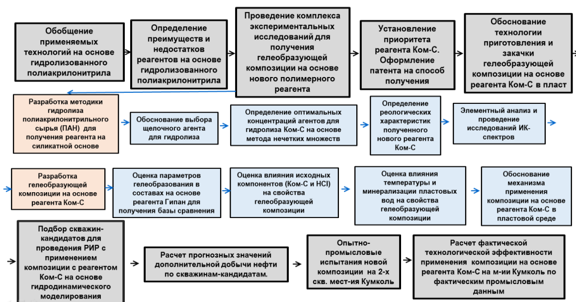
Рисунок 8 – Алгоритм принятия решения по повышению успешности применения технологии внутрислоевой водоизоляции с помощью нового реагента Ком-С на основе гидролизованного полиакрилонитрила
