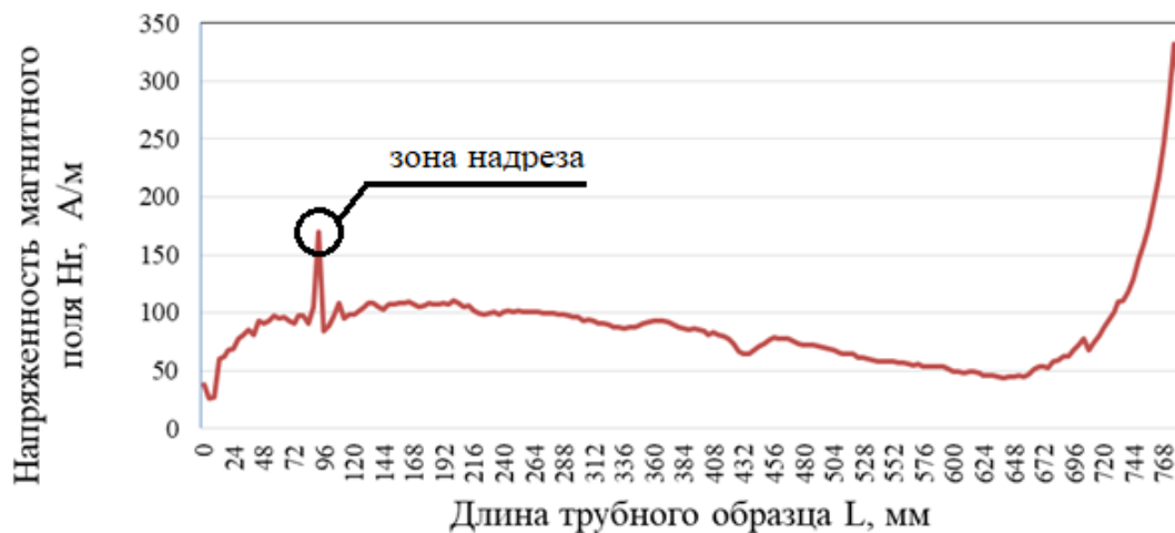
Рисунок 7 – Зависимость результирующей напряженности магнитного поля от длины рабочей зоны трубного образца при изгибающих деформациях без намагничивания
