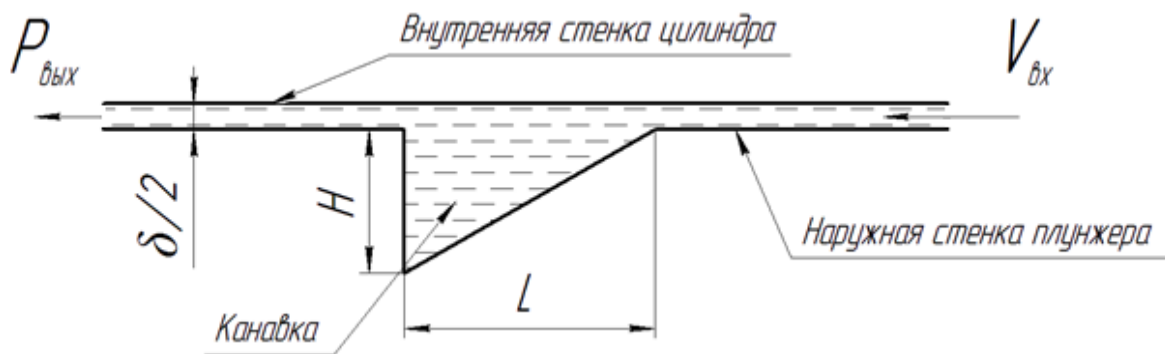
Рисунок 1 - Расчетная схема моделирования течения жидкости в зазоре плунжерной пары с канавкой
