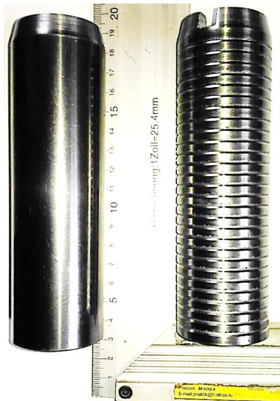
Рисунок 10 – Плунжер гладкий (слева) и с кольцевыми канавками (справа) в форме прямоугольного треугольника (ширина канавки составила 1,5 мм, глубина 0,6 мм)
