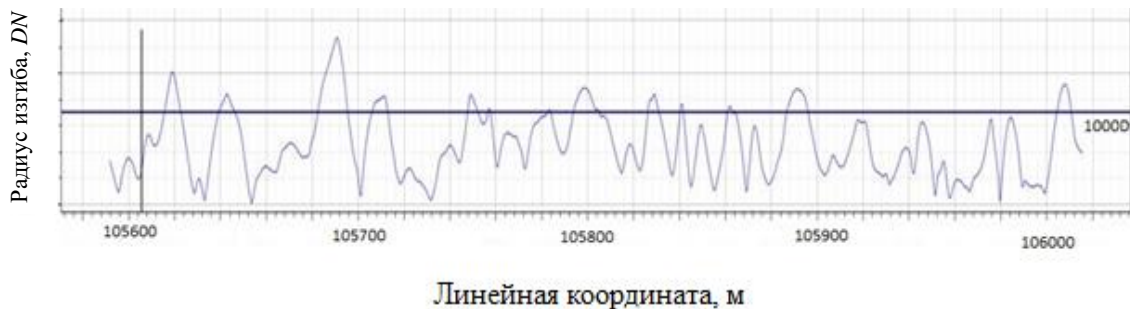
Рисунок 5 – График радиусов изгиба прямолинейного участка МГ диаметром 1420 мм
