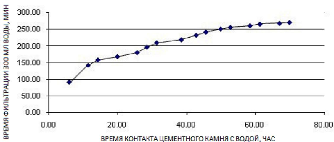
Рисунок 1 – Исследование образца цементного камня на проницаемость
