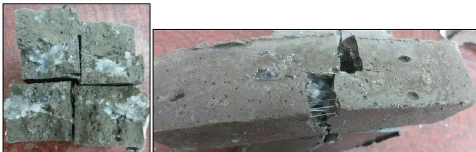
Рис. 4.2 - Образцы камня с добавкой ПАА (1%) после испытания на изгиб
