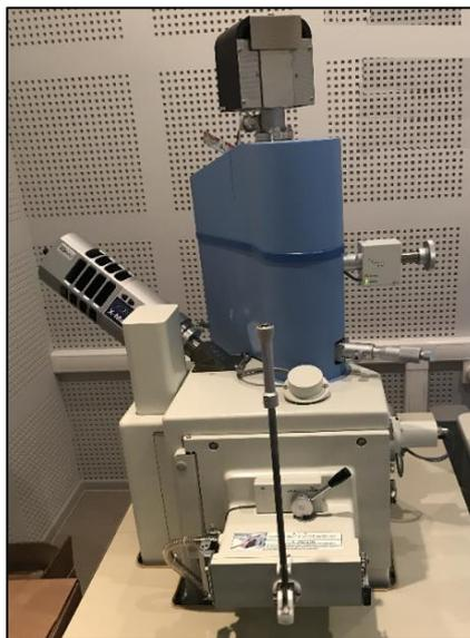
Рис. 3.3 – Оборудование для исследования толщины оболочки добавки методом растровой электронной микроскопии
