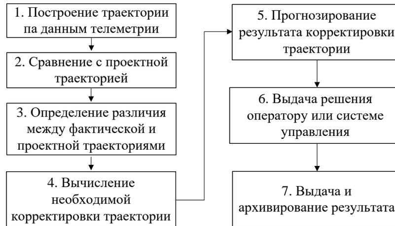
Рисунок 4 – Схема работы программы по расчету коррекции траектории
