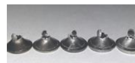
Рисунок 9 – Образцы после испытания методом SPT
