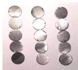
Рисунок 6 – Нарезанные на фрезерном станке мини-образцы
