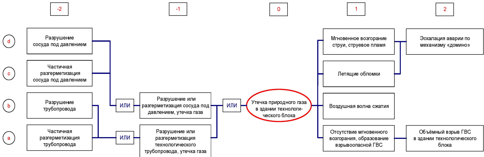
Рисунок 3 – Диаграмма "галстук-бабочка" аварии в технологическом блоке ГРС
