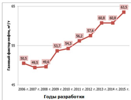
Рисунок 1 – Динамика \Gamma_{\phi} по объектам неокомского продуктивного комплекса месторождений Западной Сибири (регион Широтное Приобье) за 2006 – 2015 гг.
