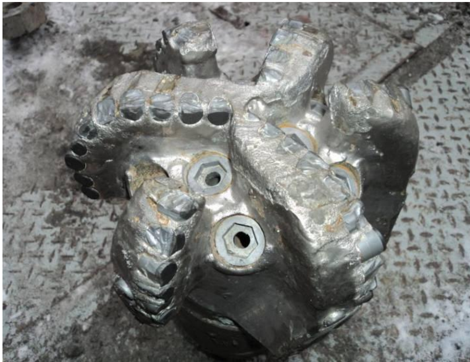
Рисунок 1 – Типичный износ вооружения после разбуривания инструмента обсадной колонны, не адаптированного под разбуривание PDC долотом
