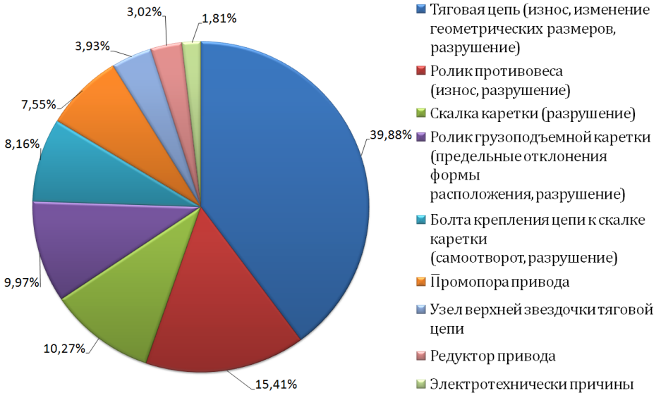
Рисунок 2 – Распределение отказов цепного привода по узлам в ОАО АНК «Башнефть»
