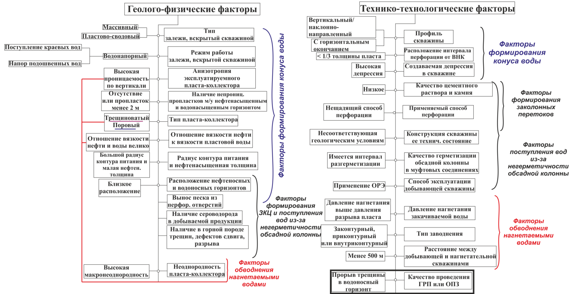
Рисунок 2 – Геолого-физические и технико-технологические факторы возникновения обводненности продукции скважин
