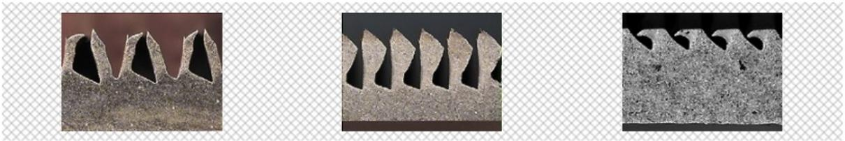
Рис. 2 - Поверхности для кипения
