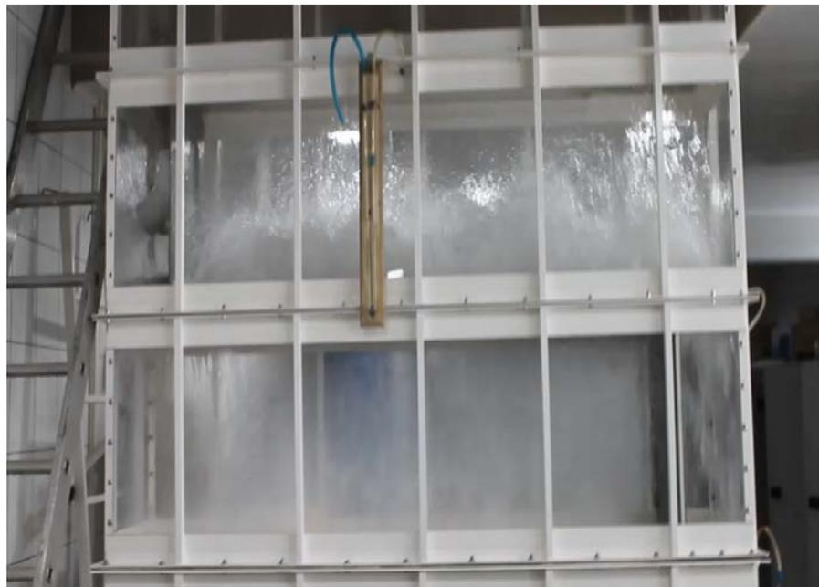
Рисунок 4.8 – Стабильный режим работы, зафиксированный на исследуемой ситчатой тарелке
