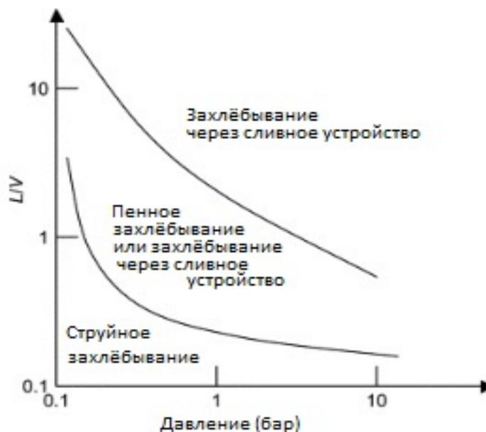
Рисунок 1.6 – Влияние давления в колонне и соотношения  $L/V$  на механизм захлёбывания
