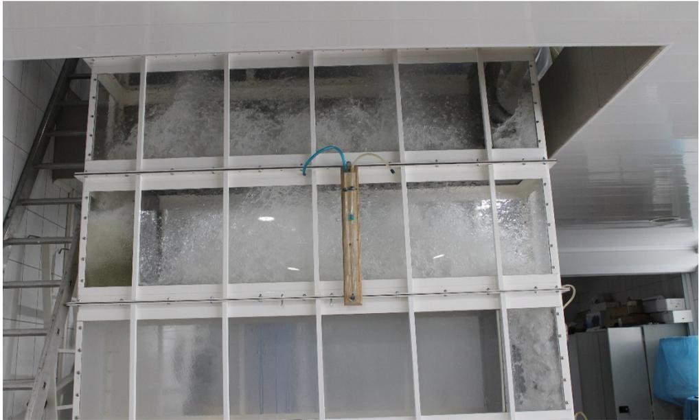
Рисунок 4.4 – Режим работы тарелки вблизи максимально-допустимых нагрузок по газу
