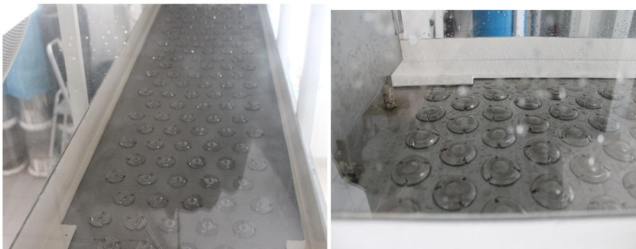
Рисунок 2.2 – Клапанные тарелки с полноподъемным клапаном
