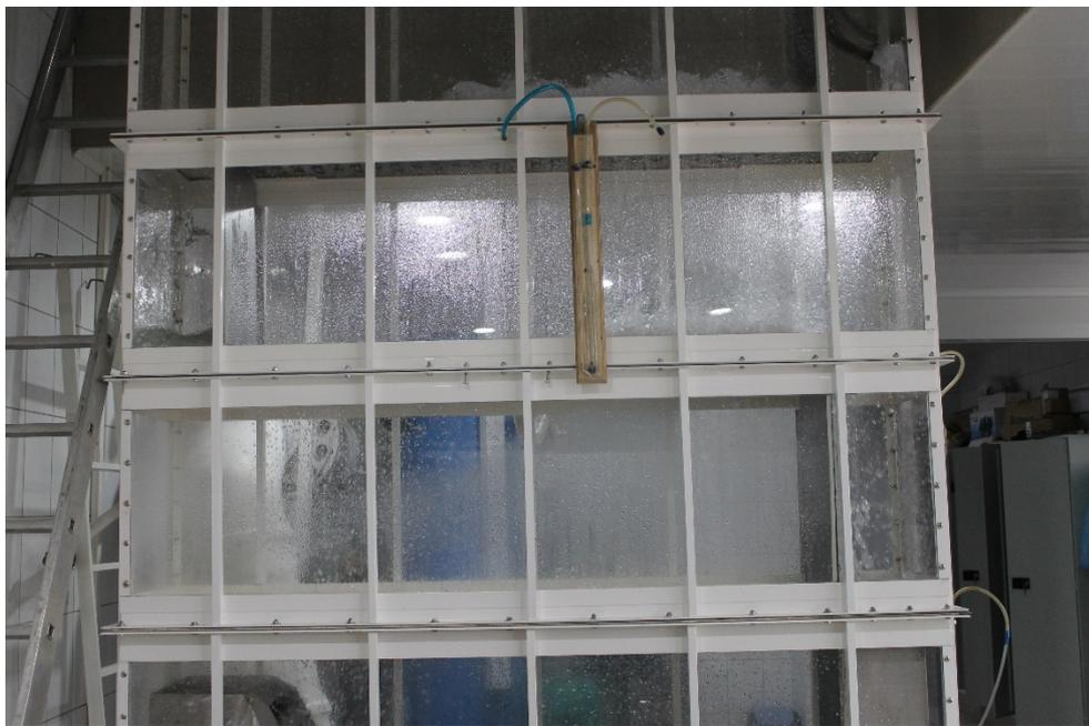
Рисунок 4.2 – Режим работы тарелки ниже минимально-допустимых нагрузок по газу
