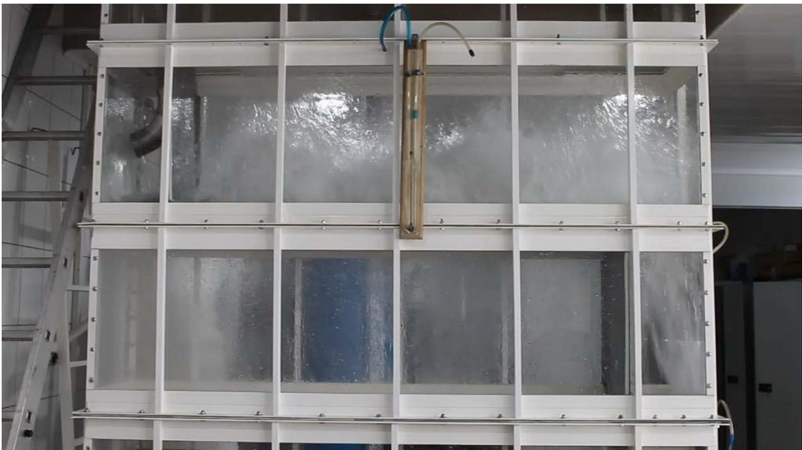
Рисунок 4.3 – Барботажный режим работы тарелки
