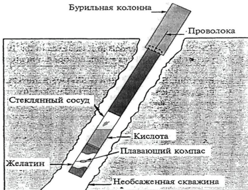
Рисунок 2.5 – Схема измерения зенитного угла и азимута скважины в 1870 г.
