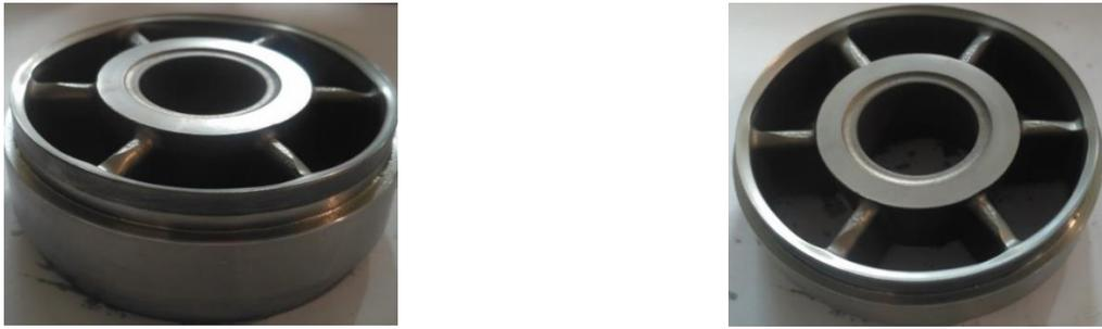
Рисунок 12 – Внешний вид решетки после гидроабразивных испытаний
