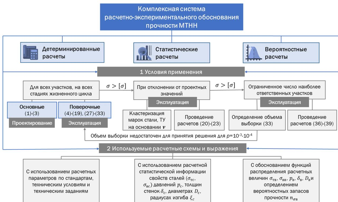
Рисунок 7 – Комплексная система расчетно-экспериментального обоснования прочности ОК
