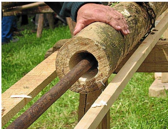
Рисунок 1 – Изготовление деревянной трубы
