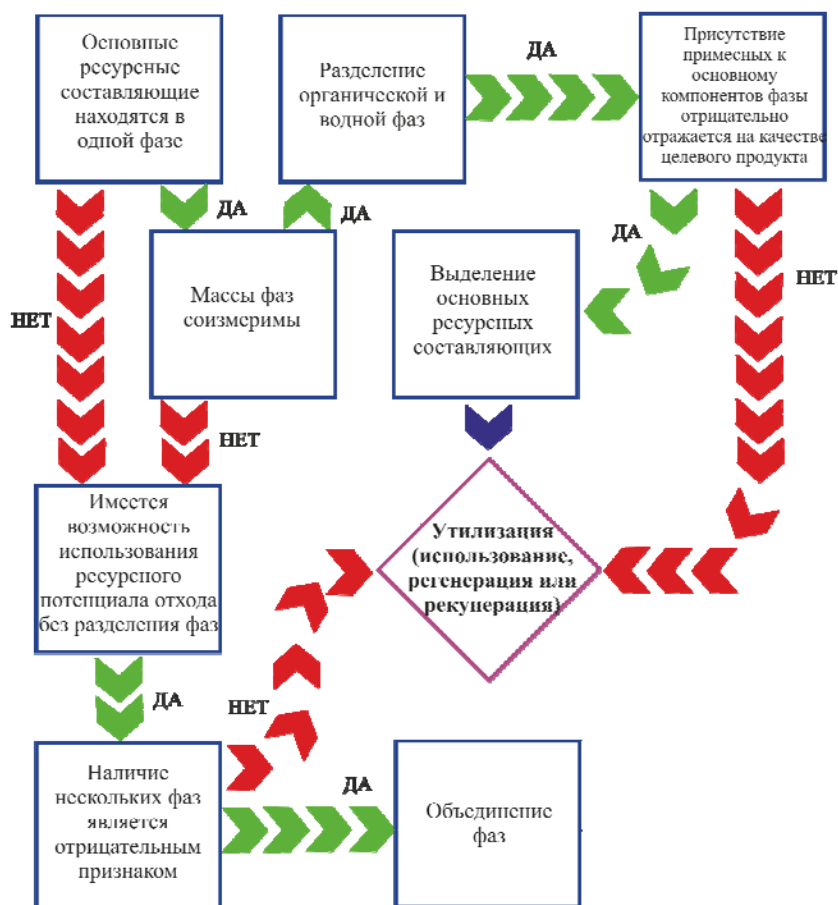
Рисунок 6 - Алгоритм реализации принципа комплементарности фаз при проектировании технологических систем утилизации отходов химии, нефтехимии
