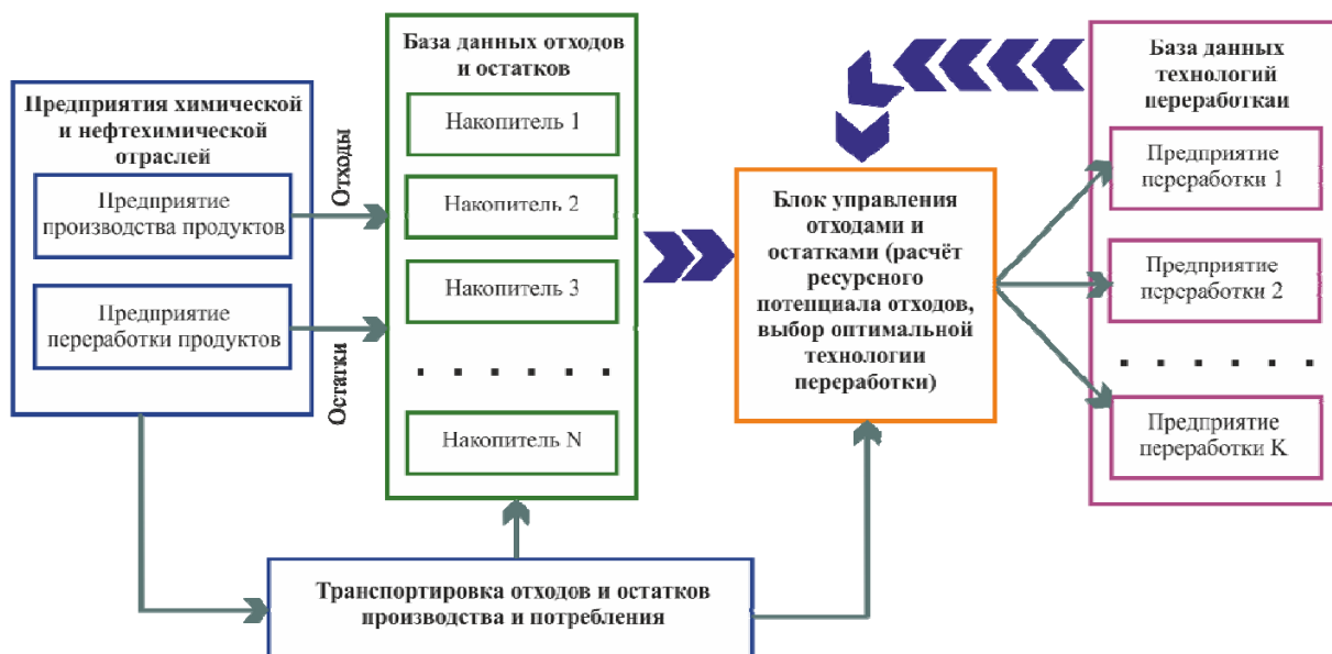
Рисунок 1 - Структурно-функциональная схема системы управления отходами производства и потребления предприятий химической и нефтехимической отраслей промышленности
