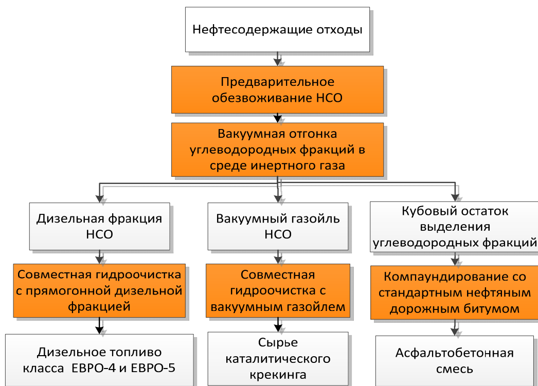
Рисунок 8 - Блок-схема технологической системы получения углеводородных фракций на основе нефтесодержащих отходов
