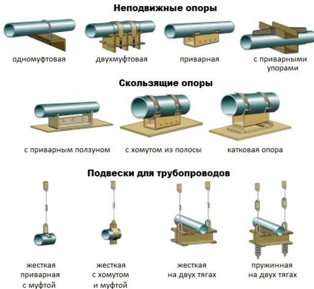
Рисунок 1.11 – Существующие виды опор и подвесок для трубопроводов
