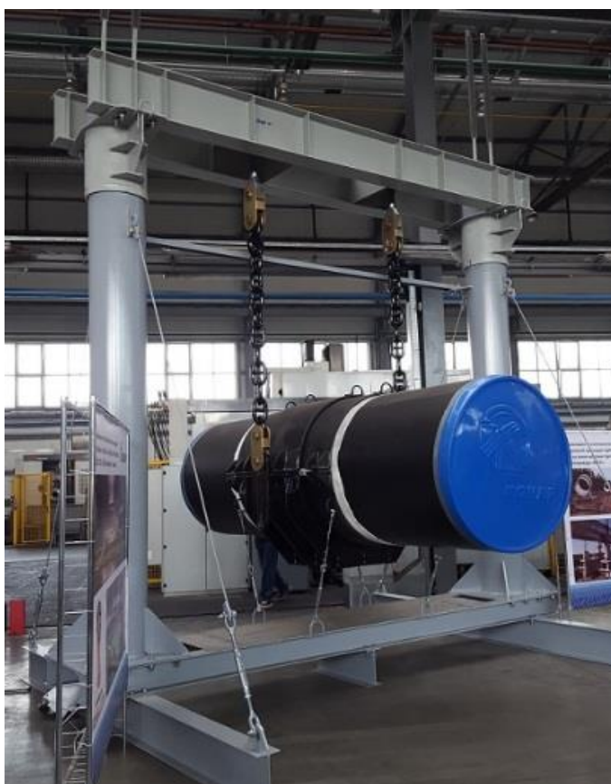
Рисунок 3.1 – Подвесная опора (патент ПАО «Транснефть»)
