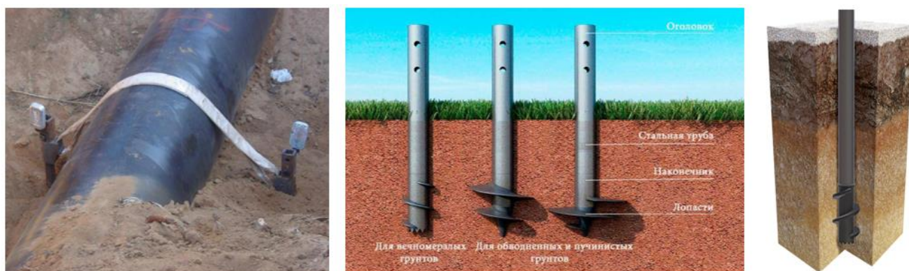
Рисунок 3.3 – Точечное закрепление трубопроводов анкерными устройствами
