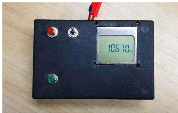
Рисунок 4.10 – Цифровой модуль для определения усилий
