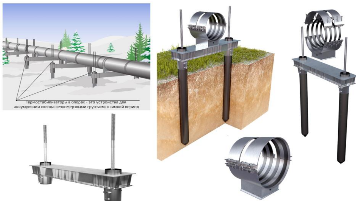
Рисунок 1.7 – Укладка на опорах в многолетнемерзлых грунтах
