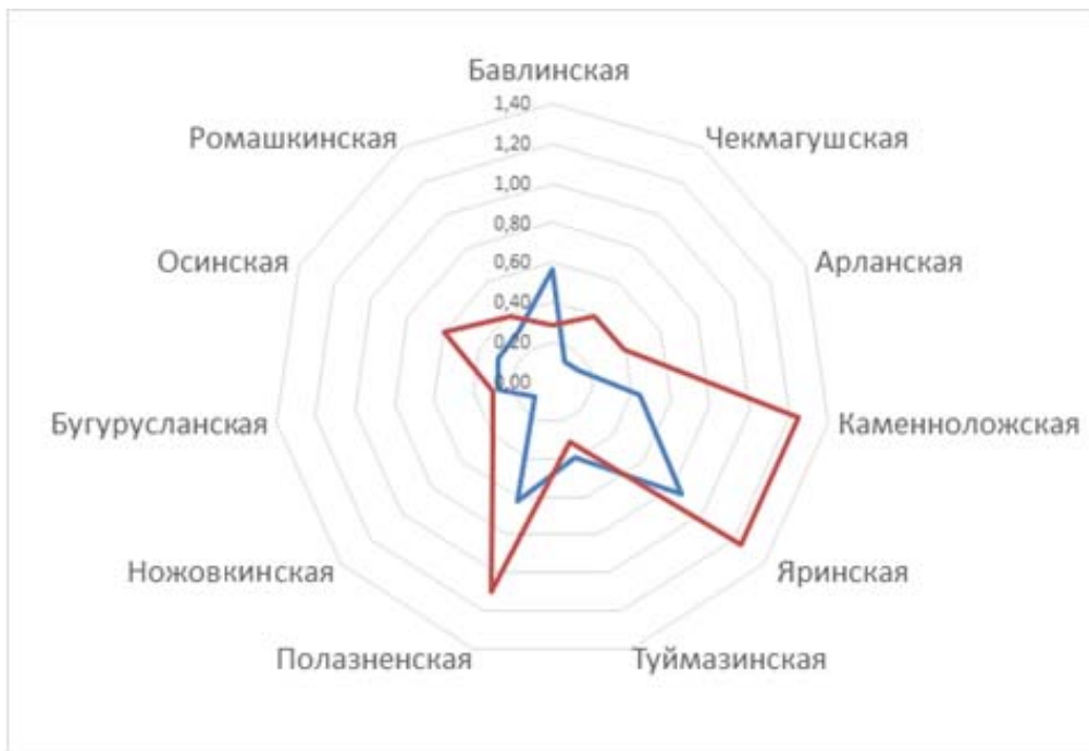
Рисунок 3 – Зависимость интенсивности выпадения отложений (частоты периодической очистки нефтепровода) от критерия нестабильности нефти
