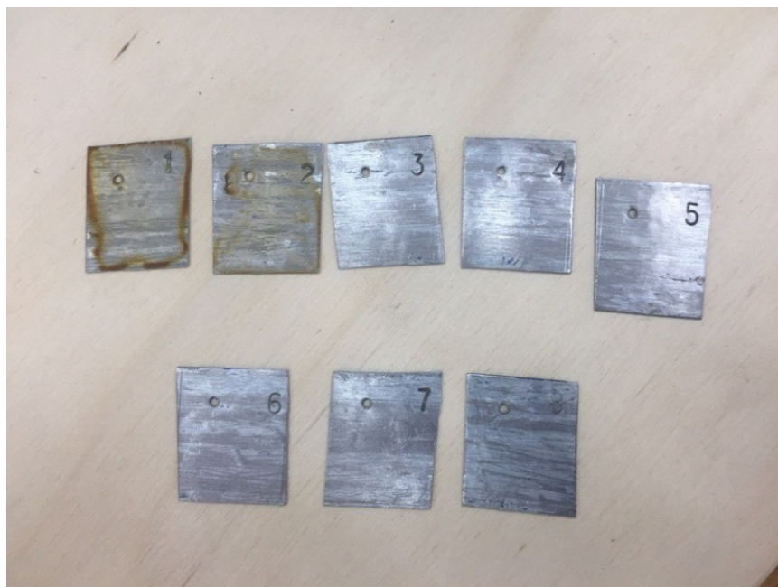
Рисунок 34 – Результаты осмотра купонов после выдержки и зачистки (1,2 – погружались без АСПО; 3-8 – с нанесением защитного слоя АСПО)
