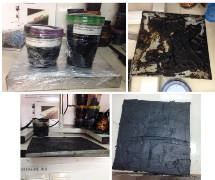
Рисунок 30 – Набивка форм отложениями нефти для испытаний
