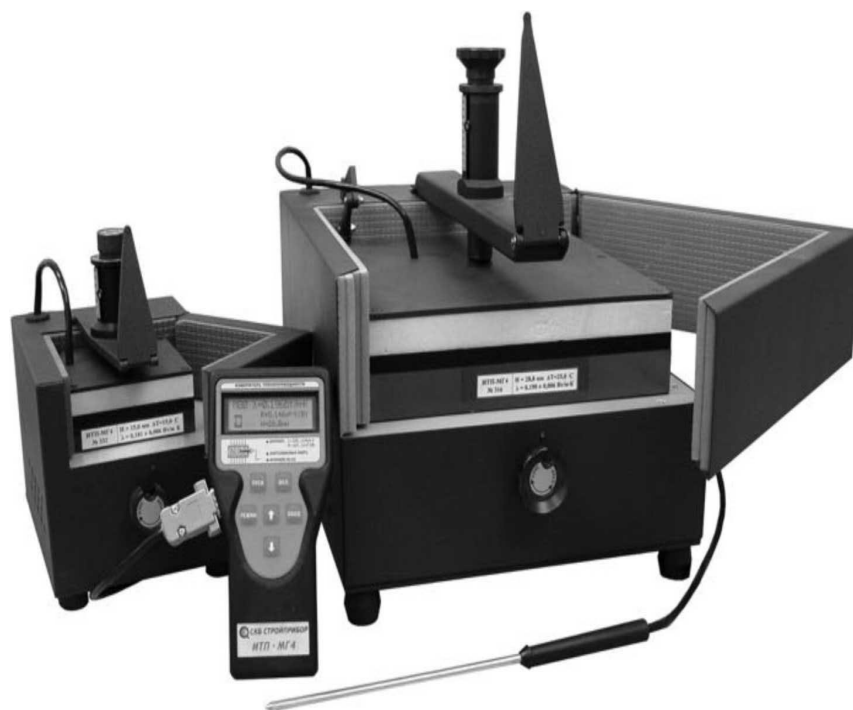
Рисунок 25 – Общий вид прибора ИТП-МГ4 с установками для испытания образцов различного размера и выносным измерительным зондом
