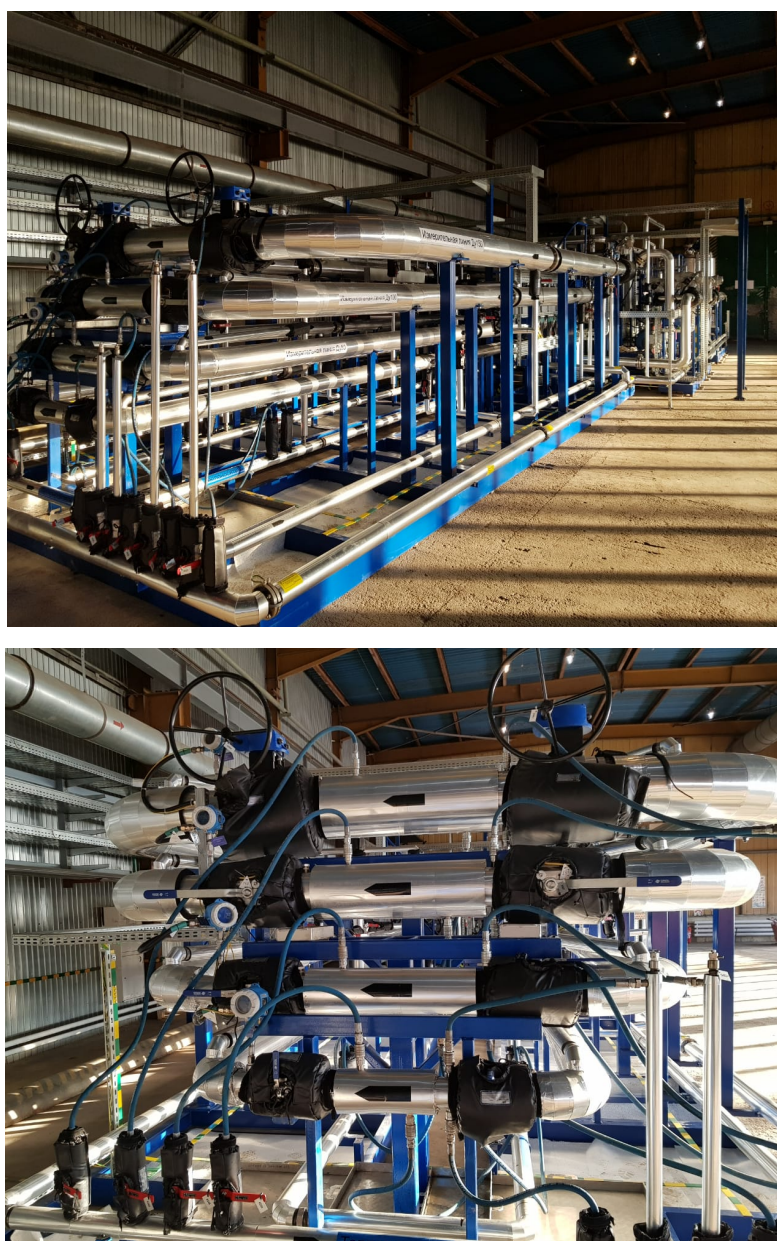
Рисунок 48 – Общий вид стенда для исследований процессов парафинизации магистральных нефтепроводов (НТЦ ООО «НИИ Транснефть», г. Уфа)
