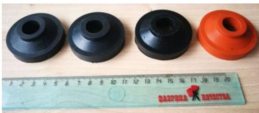
Рисунок 23 – Изготовленные экспериментальные виброизоляторы с формой типа В-45-27-5 из материалов слева направо: ИРП1346, ИРП1347, ИРП1348, СКФ-32
