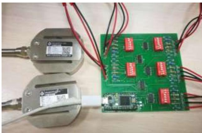
Рисунок 3 – Экспериментальный прототип для измерения тензометрического сигнала, сбора данных и передачи их на компьютер
