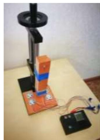
Рисунок 24 – Механический пресс, оснащенный цифровым измерителем нагрузки
