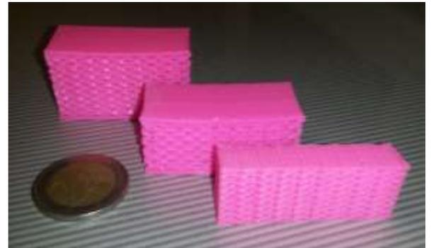
Рисунок 37 – Образцы виброизоляционного метаматериала
