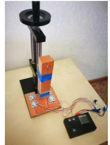
Рисунок 22 – Механический пресс, оснащенный цифровым измерителем нагрузки
