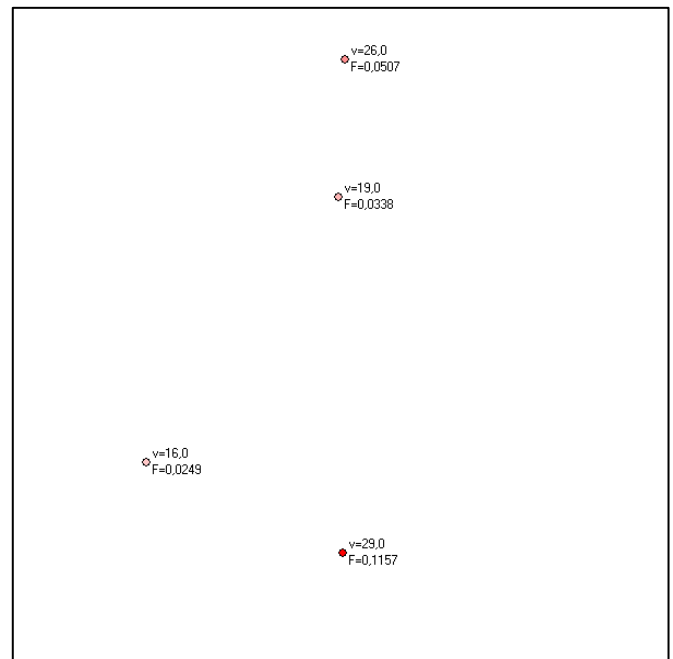
Рисунок 13 – Результаты расчета местоположения источников возбуждения с модулем распознавания источников возбуждения
