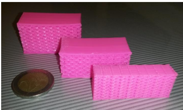
Рисунок 33 – Образцы виброизоляционного метаматериала
