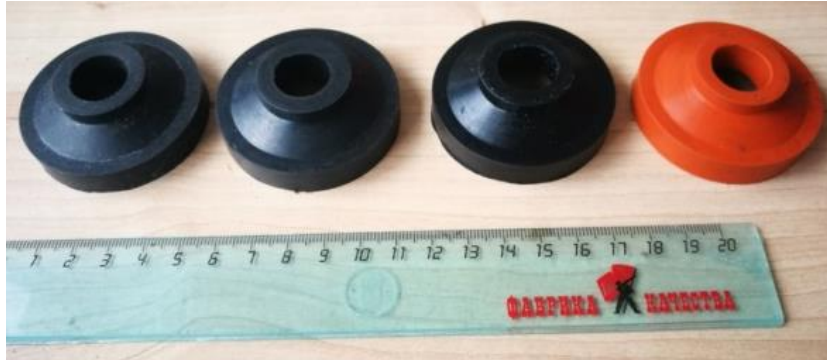
Рисунок 21 – Изготовленные экспериментальные виброизоляторы с формой типа В-45-27-5 из материалов слева направо: ИРП1346, ИРП1347, ИРП1348, СКФ-32
