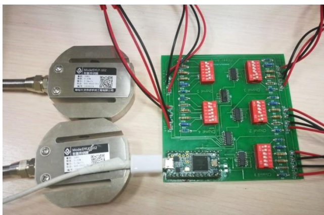
Рисунок 5 – Экспериментальный прототип для измерения тензометрического сигнала, сбора данных и передачи их на компьютер
