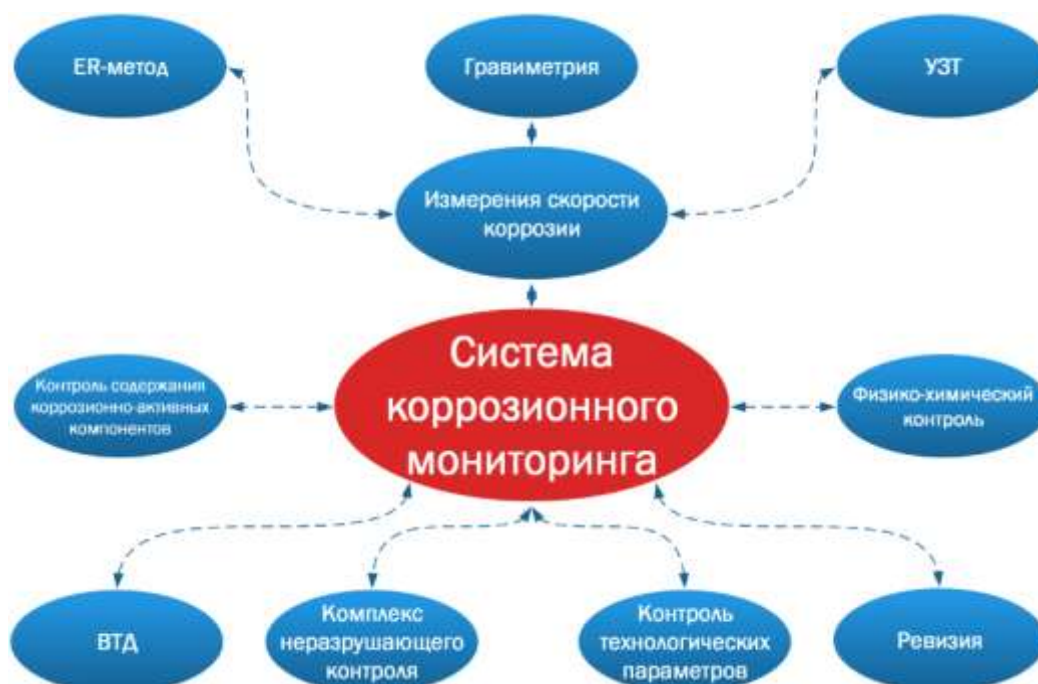
Рисунок 54 – Принципиальная схема системы коррозионного мониторинга объектов ачимовских отложений УНГКМ
