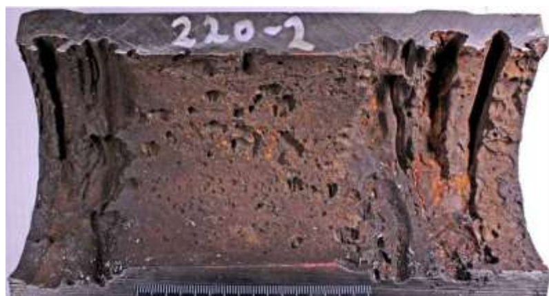
Рисунок 11 – Внешний вид фрагмента трубопровода обвязки скважины №2АЧ151, подверженной типовым повреждениям
