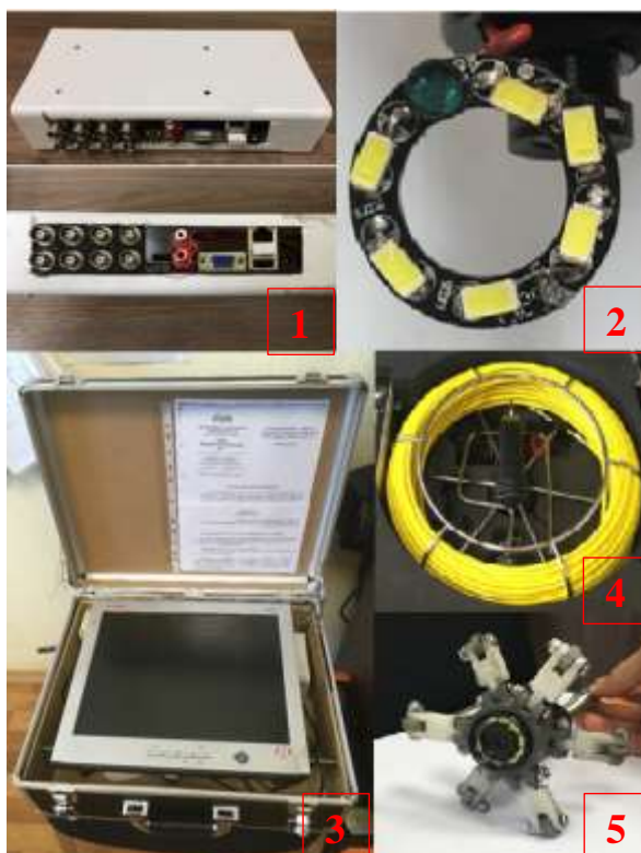
Рисунок 21 – Сконструированный видеозендоскоп: 1 – цифровой видеорегистратор; 2 – светодиодная подсветка; 3 – ЖК-монитор; 4 – гибкий кабель; 5 – камера с установленным устройством пропуска камеры через отводы
