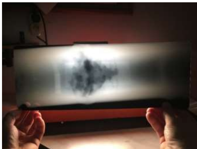
Рисунок 20 – Фотоматериал просмотра на негатоскопе снимка трубы с коррозионными дефектам в области сварного шва
