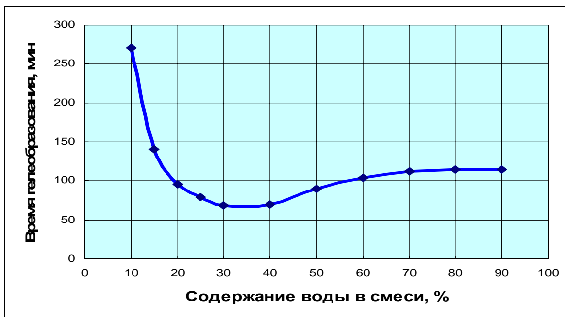
Рисунок 1 – Характеристика процесса гелеобразования метилэтилфенилэтоксисилоксана в присутствии воды
