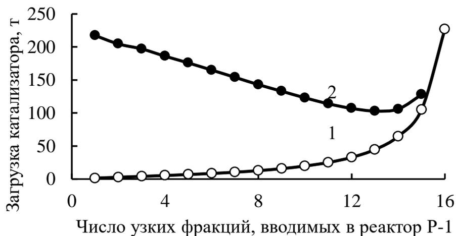
1 – загрузка катализатора в реактор P-1, 2 – загрузка катализатора в оба реактора
