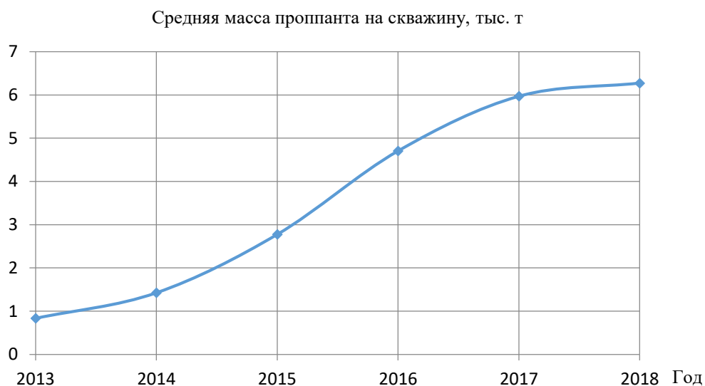
Рисунок 2.13 — Динамика изменения массы проппанта при проведении операций ГРП в скважинах, пробуренных в Пермском бассейне
