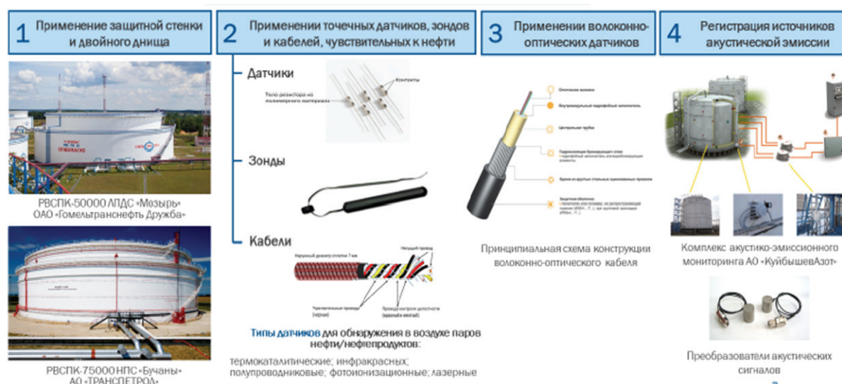
Рисунок 19 – Основные технологии методов защиты резервуаров от утечек
