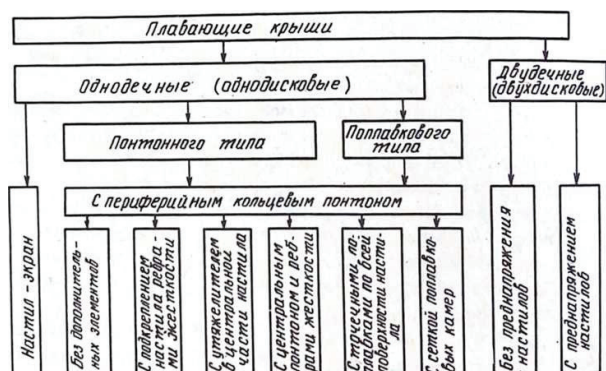
Рисунок 12 – Классификация конструкций плавающих крыш
