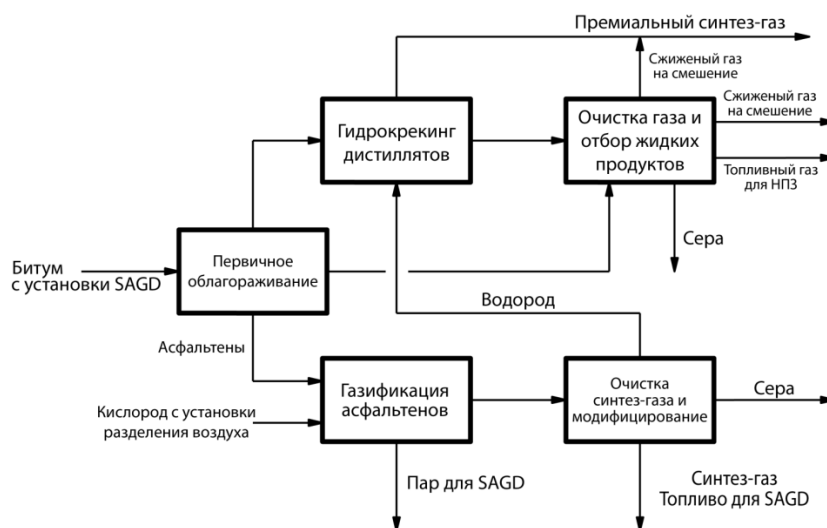
Рисунок 1.9.3 – Схема облагораживания тяжелой нефти из битуминозного песка
