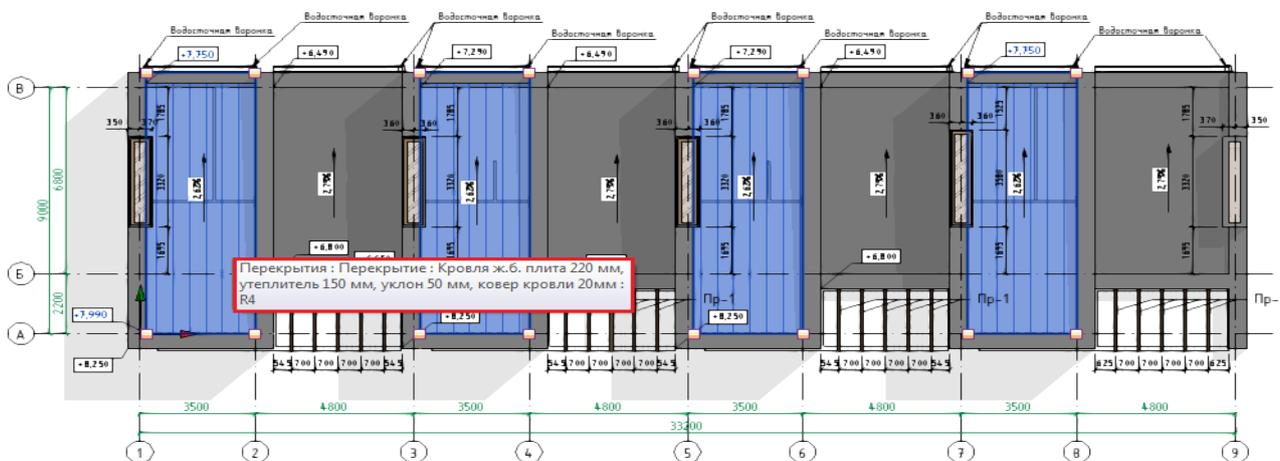
Рисунок 2 - Вариант проектного решения крыши малоэтажного жилого объекта в формате 2D-представления (чертежа графической части проекта)
