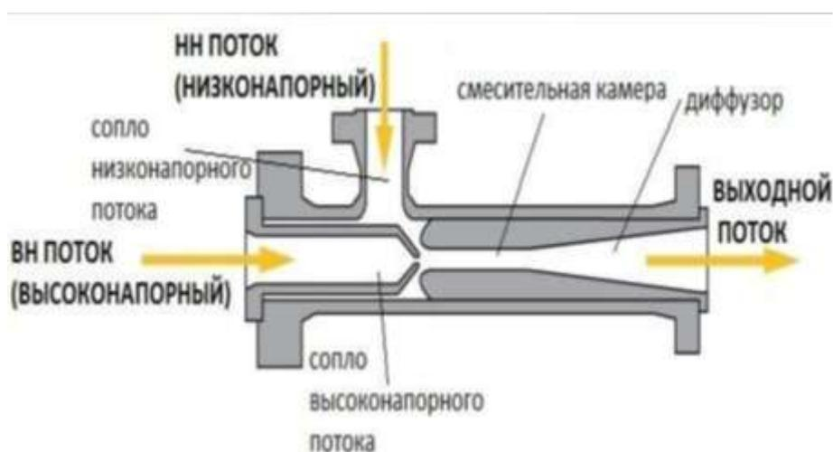
Рисунок 1.17– Струйный инжектор (схема)
