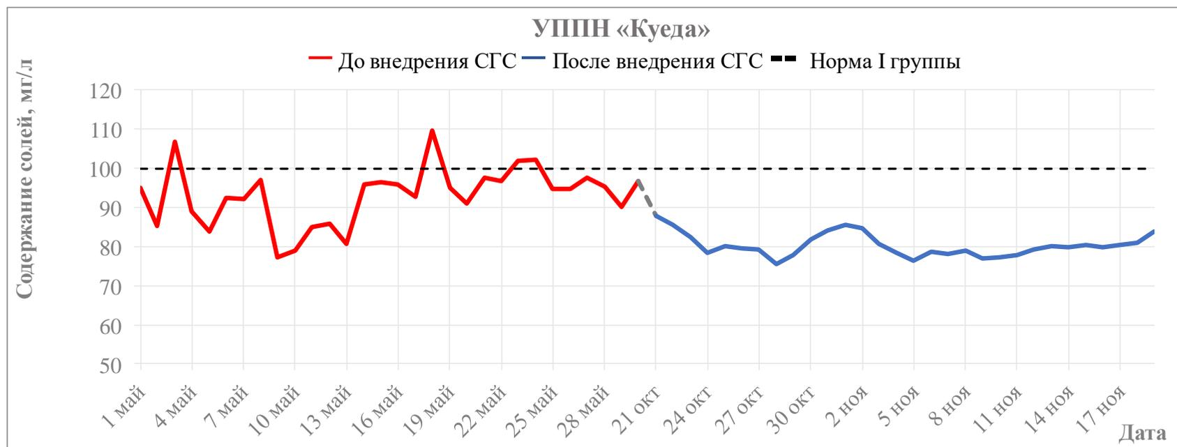
Рисунок 4.11 – Сравнительные графики содержания солей до и после внедрения СГС на УППН «Куеда»
