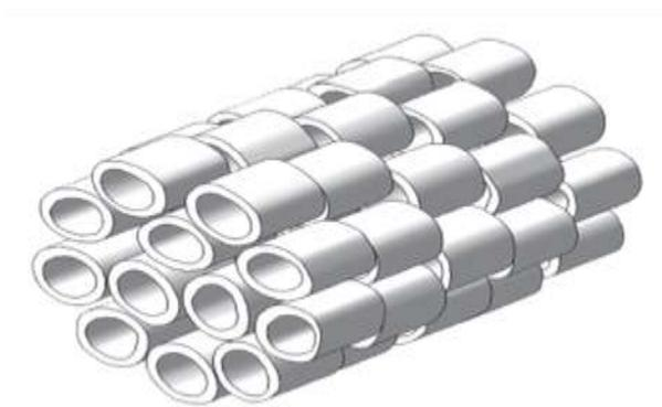
Рисунок 1.10– Геометрия модели насадочного слоя из колец Рашига
