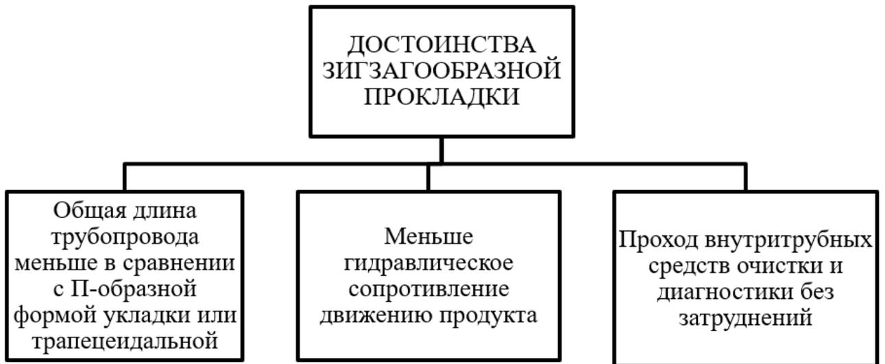
Рисунок 1.6 – Достоинства зигзагообразной схемы прокладки магистральных трубопроводов
