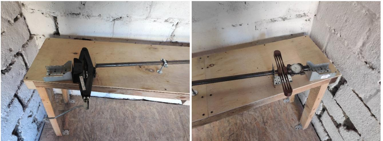
Рисунок 3.7 – Создание сжимающего усилия в трубе с помощью механического домкрата и измерение с помощью динамометра сжатия
