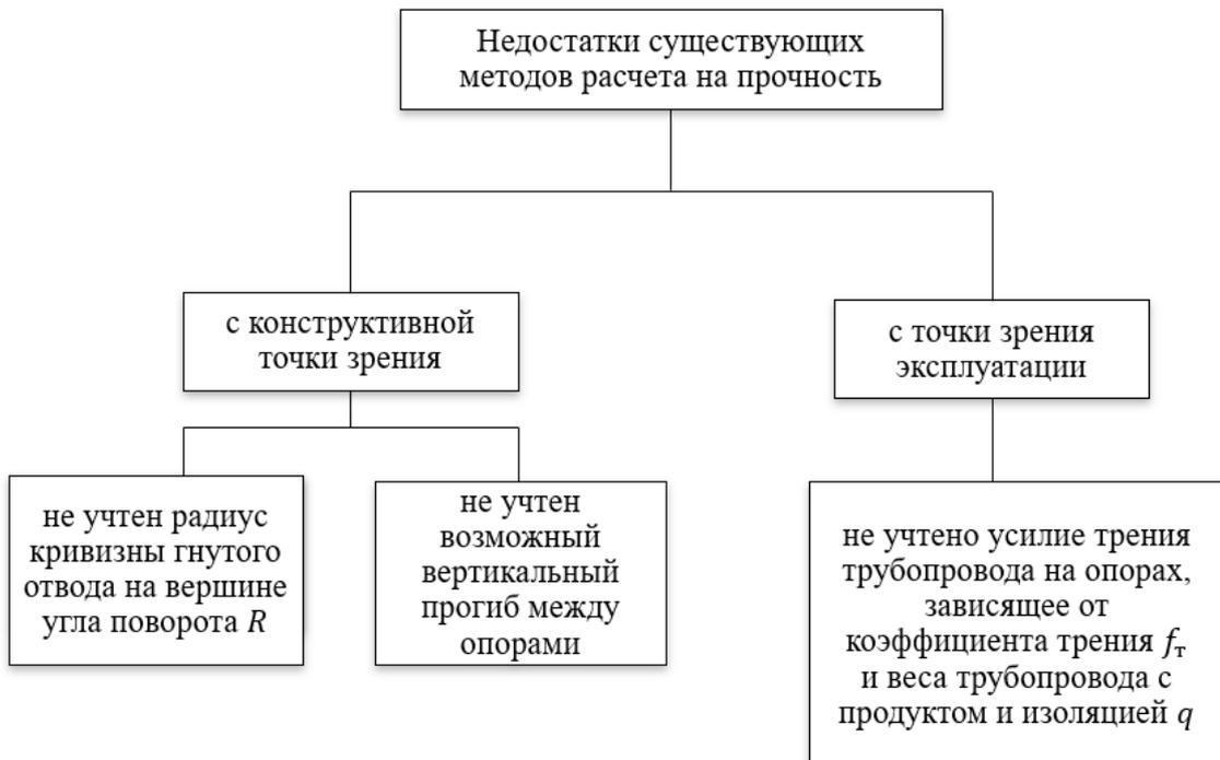
Рисунок 1.7 – Недостатки существующих методов расчета на прочность зигзагообразных участков трубопроводов
