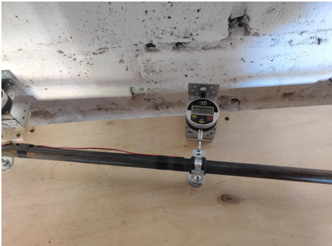
Рисунок 3.9 – Замер поперечных перемещений участка трубы под действием сжимающего усилия
