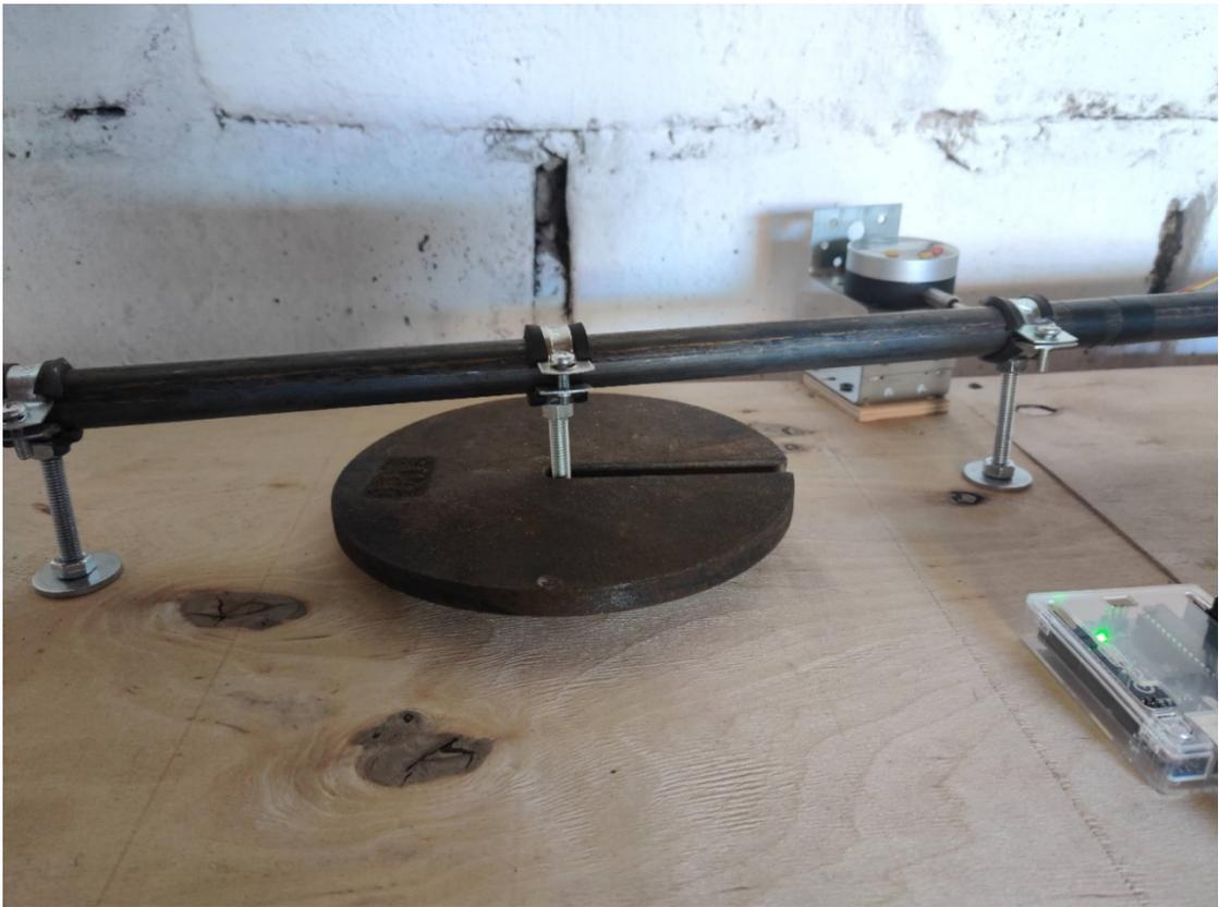
Рисунок 3.6 – Создание распределенной поперечной нагрузки на трубу с помощью тарированных грузов
