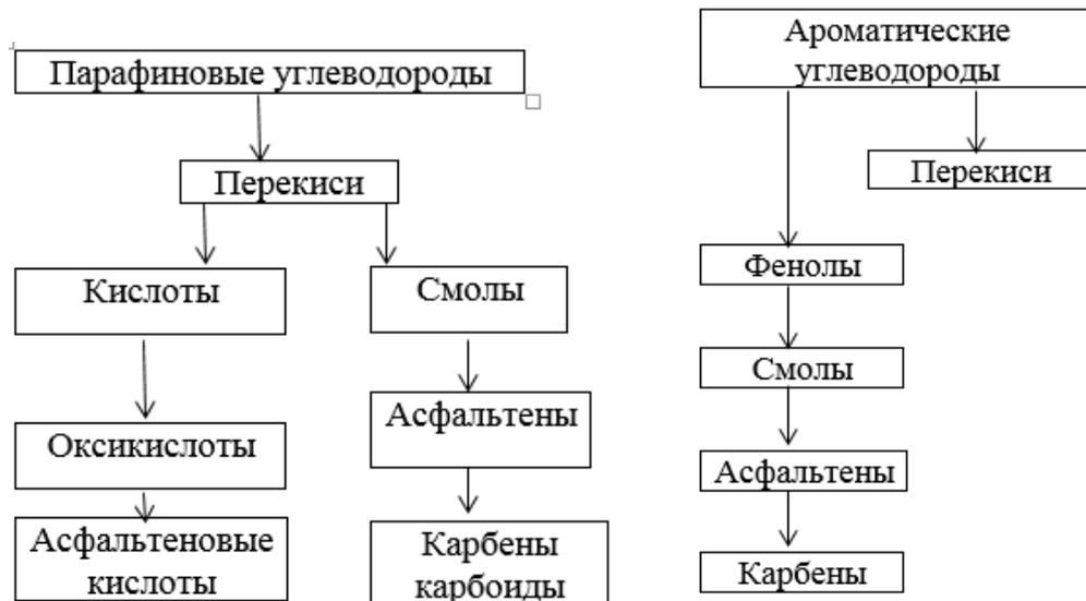
Рисунок 4.7 – Схема окисления и полимеризации парафиновых и ароматических углеводородов
