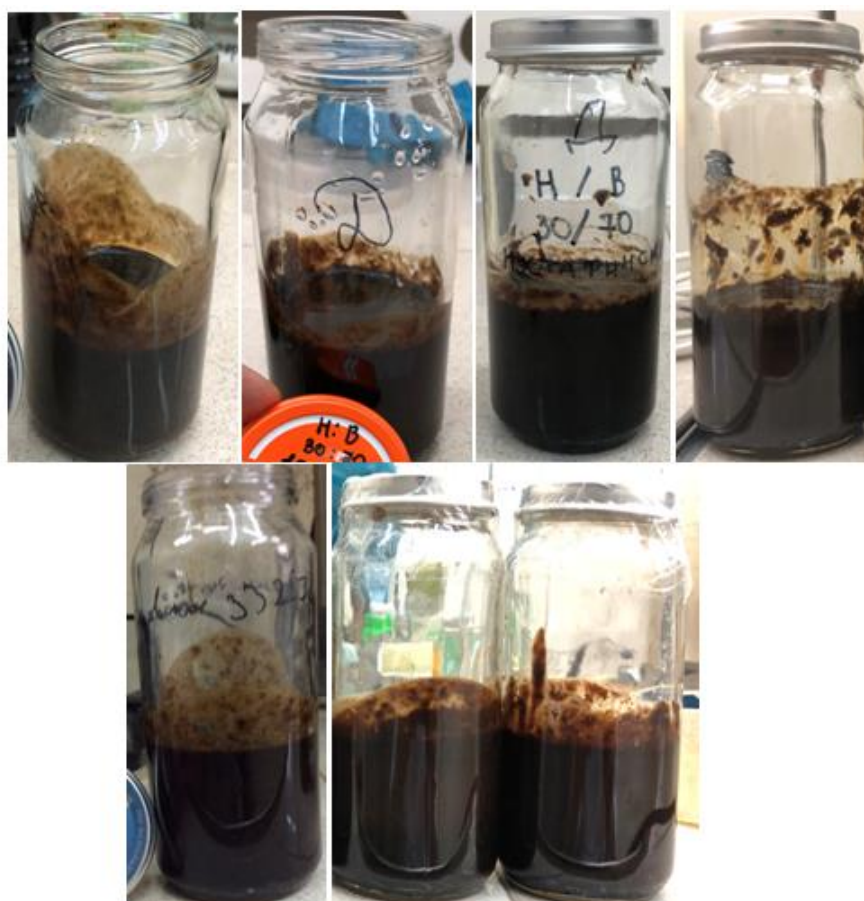
Рисунок 55 – Внешний вид эмульсий с добавлением 8 % эмульгатора «А» термостойкий (верхний ряд: 1782, 10КНД, 162, 123; нижний ряд: 3327, 7УЗБ, 2638)
