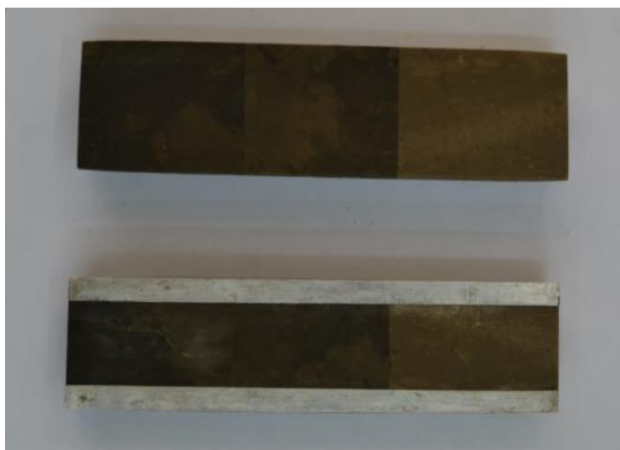
Рисунок 67 – Модель идеальной трещины
