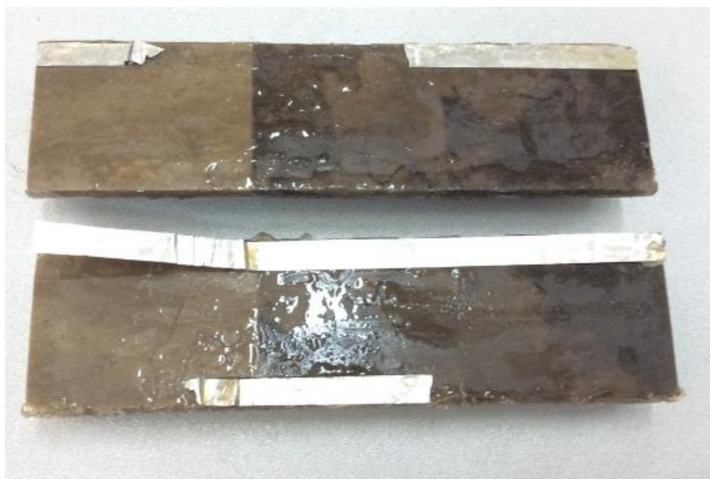
Рисунок 69 – Модель трещины после фильтрации воды через эмульсию без твердой фазы
