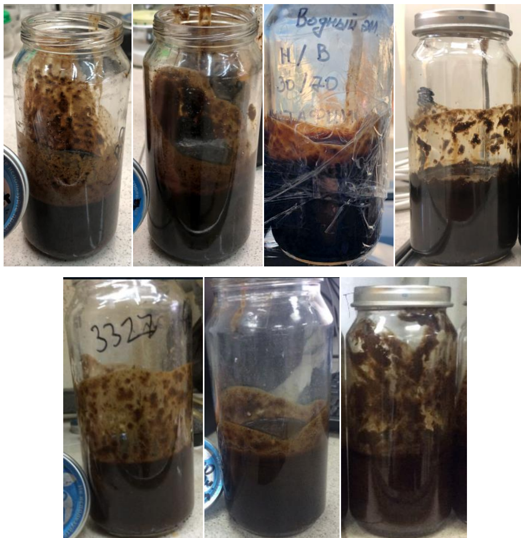
Рисунок 61 – Внешний вид эмульсий с добавлением 8 % эмульгатора «Г» (верхний ряд: 1782, 10КНД, 162, 123, нижний ряд: 3327, 7УЗБ, 2638)
