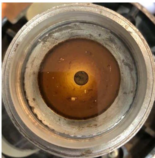
Рисунок 54 – Визуализация структуры эмульсий и ее течение в сдвиговом потоке между конусом и пластиной
