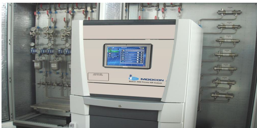
Рисунок 4.11 – Система поточного анализа нефтепродуктов компании Modcon systems ltd (Израиль) модели 3000 и Veacon 3100
