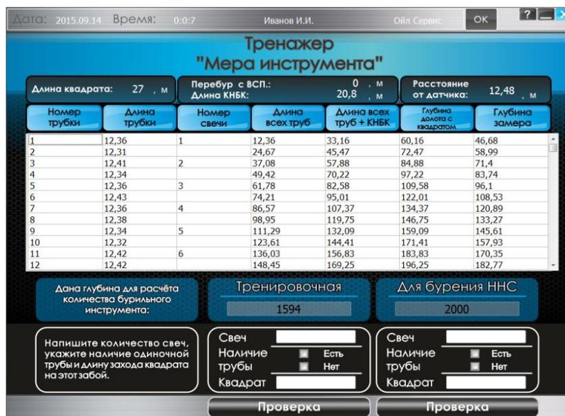
Рис. 2. Рабочий интерфейс тренажера «Мера Инструмента»
