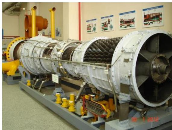
*б) газотурбинный двигатель*
