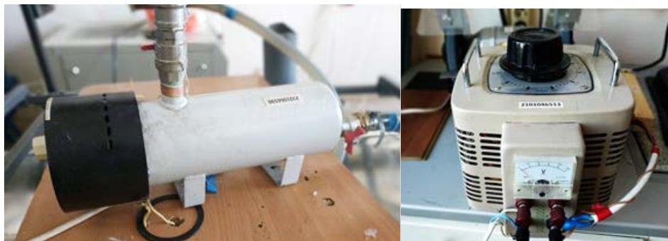
Рисунок 2.32 – Водонагреватель и регулятор мощности нагрева
