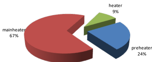
Рисунок 1 – Структура электропотребления на воздушное отопление
