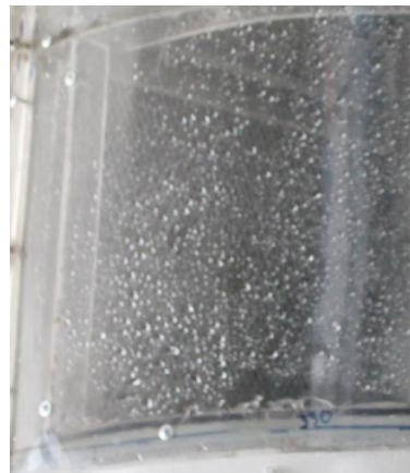
Рисунок 4.6 – Капельная жидкость на стенке стенда по исследованию насадочных каплеотбойных устройств
