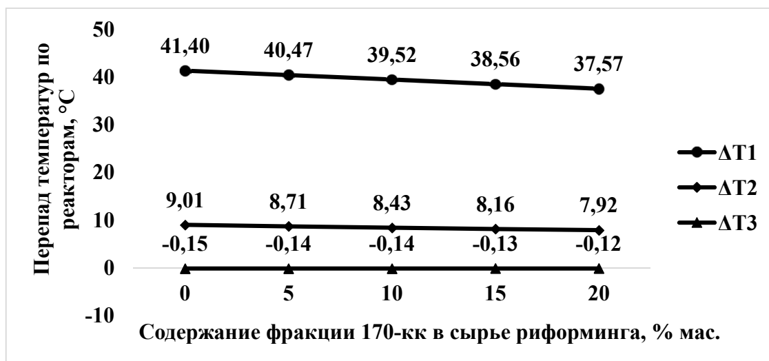
Рисунок 4.17 – Зависимость перепадов температур в реакторном блоке от содержания 170-кк в сырье риформинга
