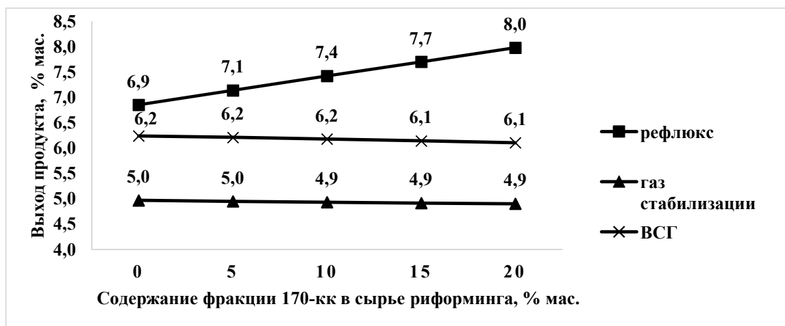
Рисунок 4.12 – Зависимость выхода газа стабилизации, рефлюкса и отдувочного ВСГ от содержания фракции 170-кк в сырье риформинга
