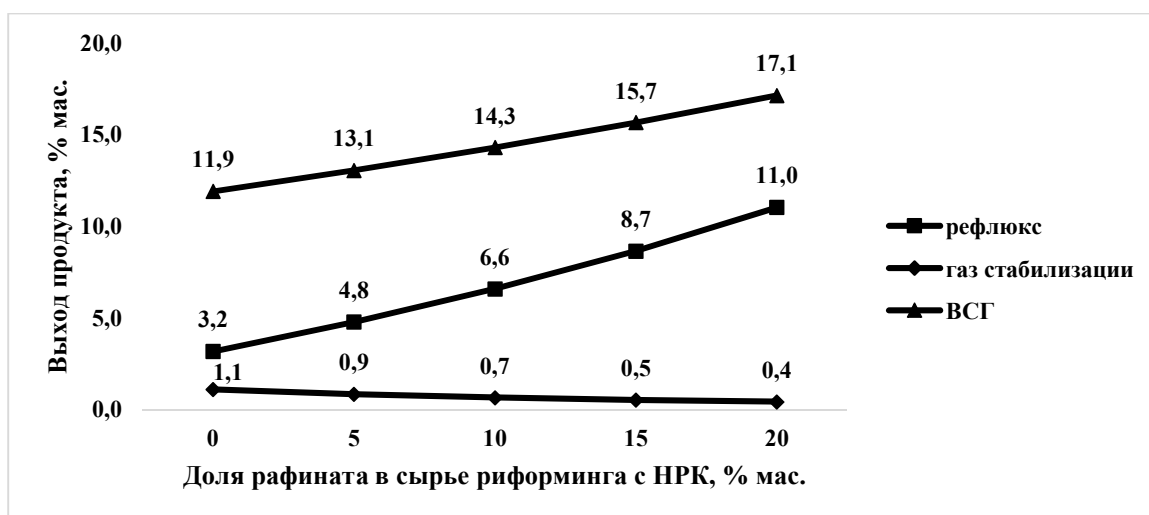
Рисунок 2 – Зависимость выхода рефлюкса, газа стабилизации и ВСГ от доли рафината в сырье риформинга
