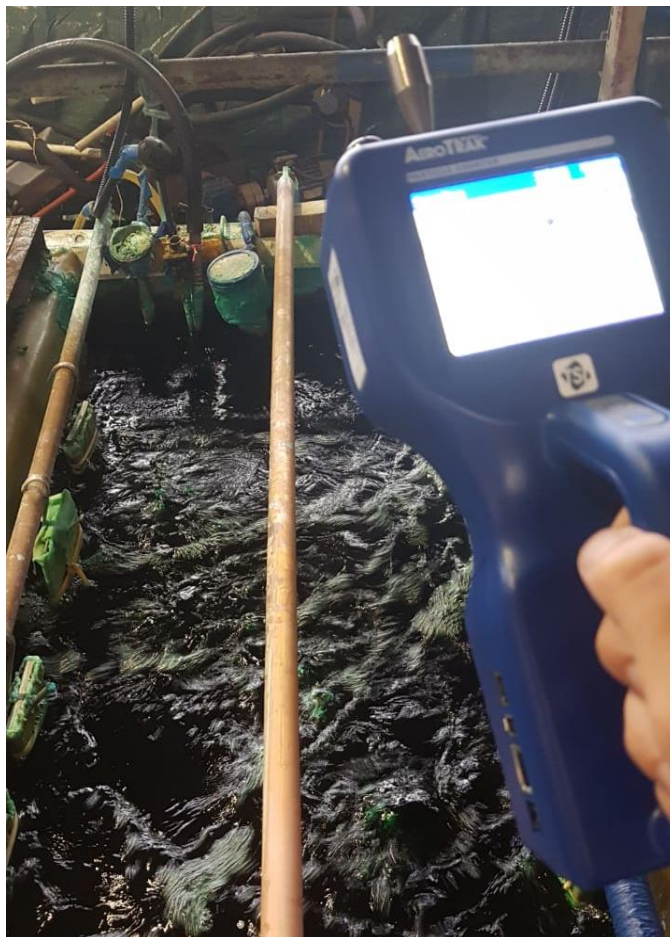
Рисунок 4. Отбор проб гальванического аэрозоля над гальванической ванной
